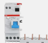
n.1 blocco differenziale 4P DDA204 A 40A 30mA cod. B427981
